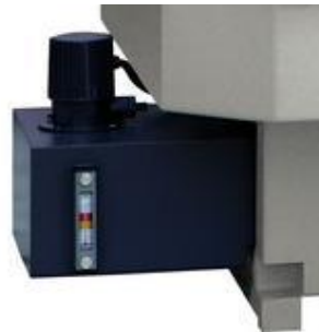
Deposito de refrigerante de 60 litros con indicador de nivel.
